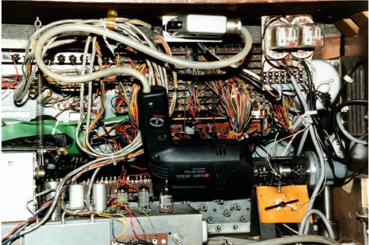
Fig. 76 Een boormachine drijft het transportsysteem van de B3 aan, ontwikkeld door A.van Ooyen.
